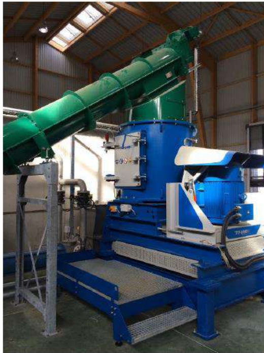
FONROCHE 47 – Villeneuve sur Lot Fourniture et mise en place d'un bio-préparateur TQZ 1200
