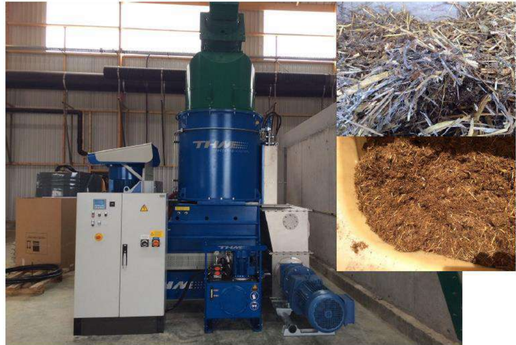
FONROCHE 47 – Villeneuve sur Lot Fourniture et mise en place d'un bio-préparateur TQZ 1200
